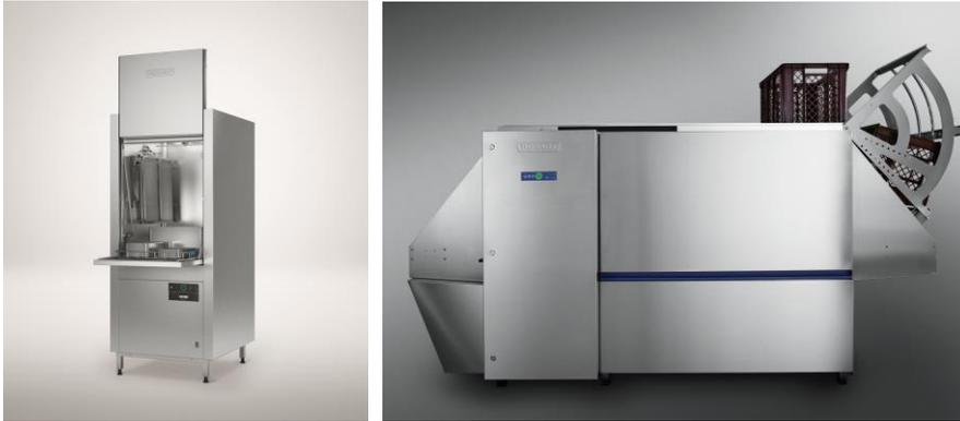
Diese Maschinen spülen wie geschnittenes Brot: die Universalspülmaschine UP mit dem innovativen seitlichen Waschsysteem (links) oder die FUX-C mit einer Kapazität von bis zu 300 Bäckerkisten pro Stunde (rechts)
